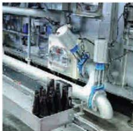
Dispozitivele de umplere și îmbutellere sunt sensibile și ar trebui controlate doar cu aer comprimat extra-uscat
