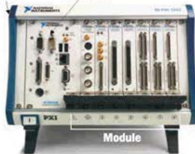
Fig. 2 - Șasiu PXI standard cu 8 sloturi, pe care sunt instalate un controler integrat de sistem și șapte module periferice
